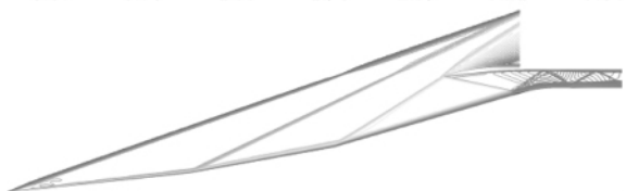
图2 进气道在 Ma=4 下流场的马赫线等值线图
