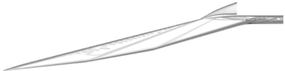
图3 进气道在 Ma=6 下流场的马赫线等值线图
